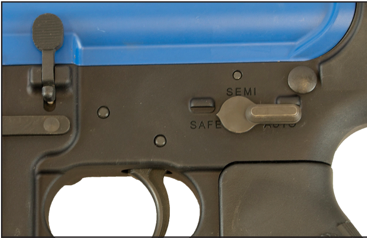
Figure 3-7 - Ejecter le chargeur
