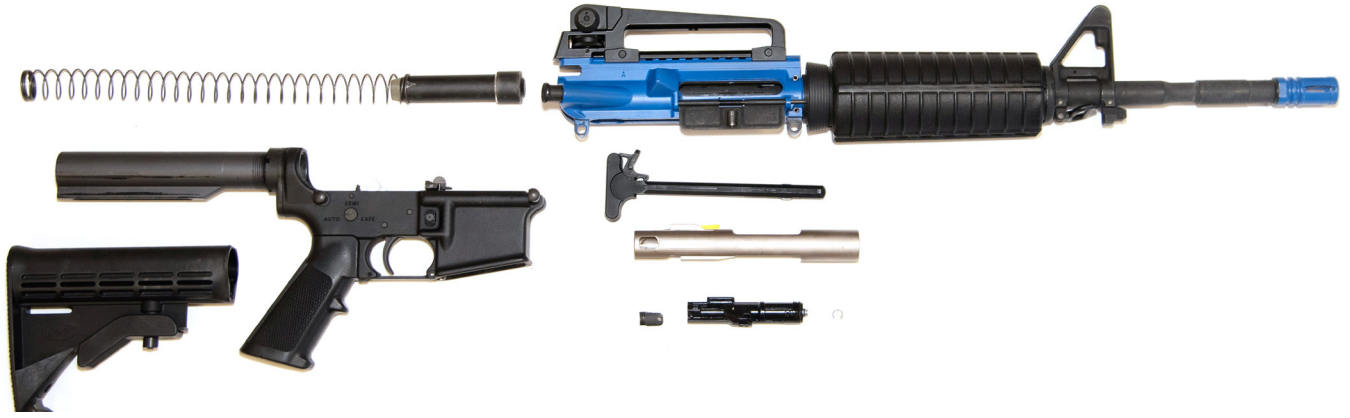
Figure 3-32 - Vue d'ensemble du démontage terrain
