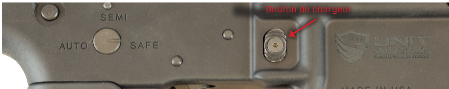
Figure 3-6 – Bouton du loquet de chargeur
