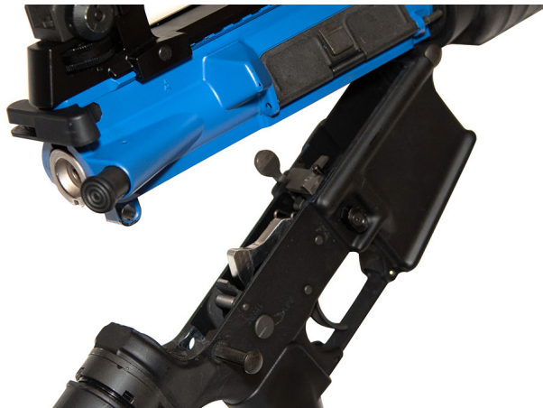
Figure 3-27 – Parties supérieure et inférieure du boîtier séparées
