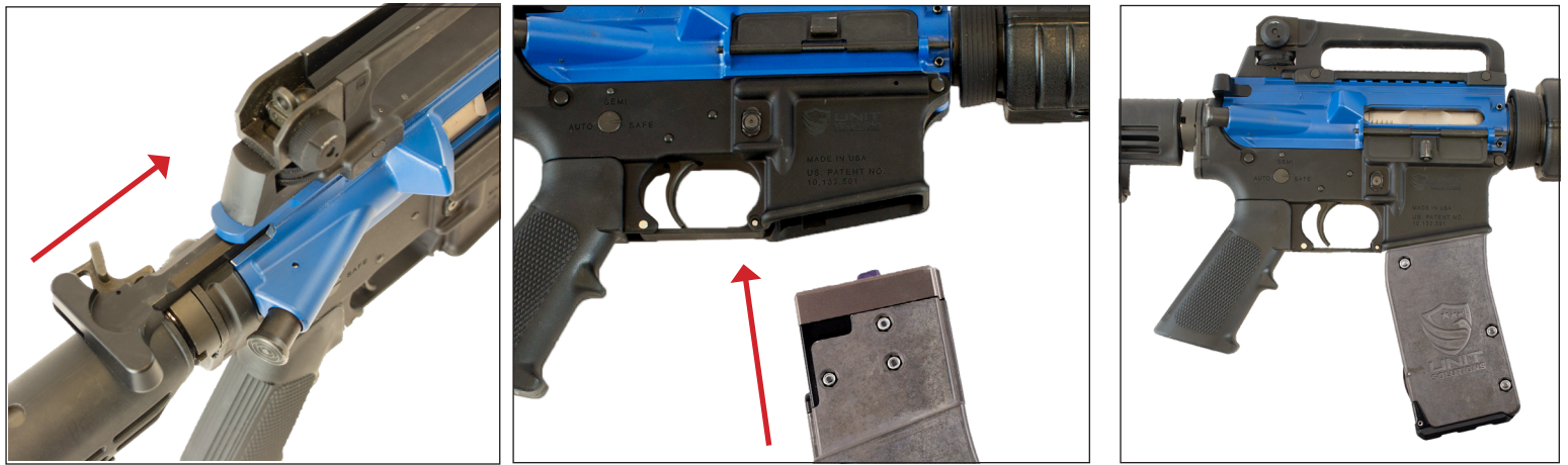
Figure 3-14 – Insérer le chargeur
