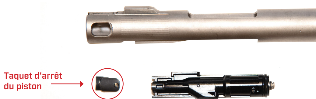
Figure 3-31 - Retrait du taquet d'arrêt du piston
