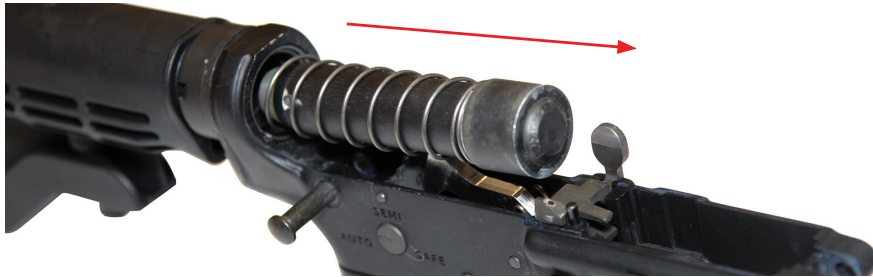
Figure 3-29 - Retrait du tampon et du ressort récupérateur
