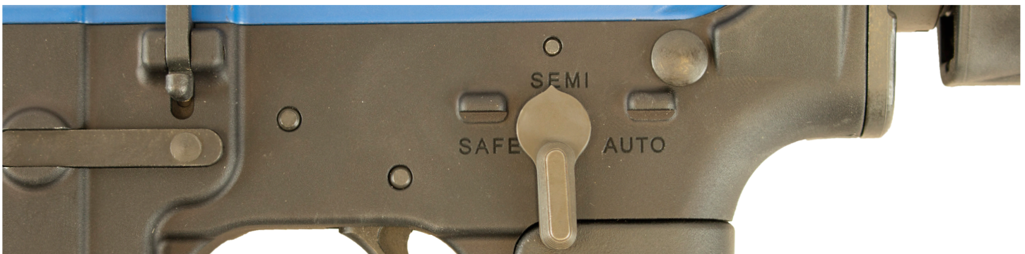
Figure 3-10 – Sélecteur de tir - SEMI
