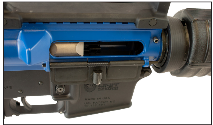
Figure 3-8 - Tirer le levier d'armement vers l'arrière
